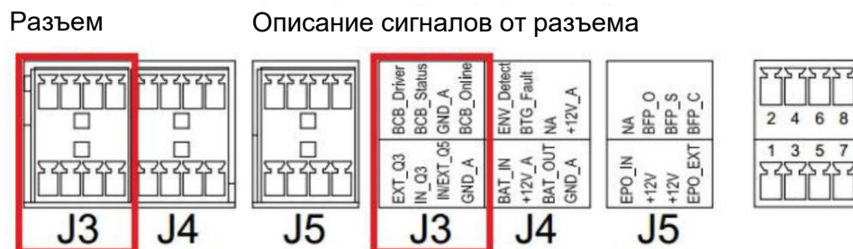
Рисунок 4-5. Интерфейсный разъем состояния выключателя сервисного байпаса, выходного выключателя и батарейного автомата.
