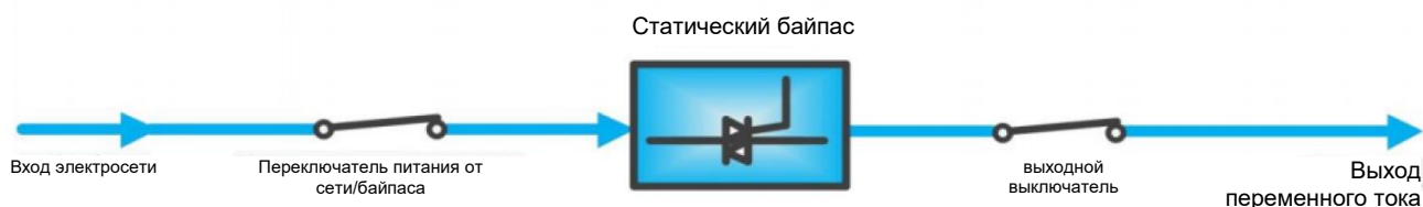
Рисунок 6-6. Принципиальная схема работы в режиме байпаса
