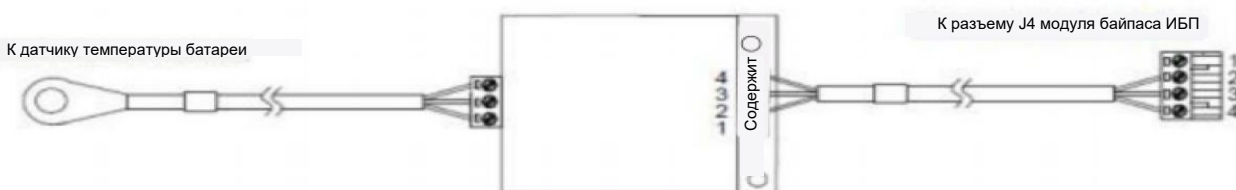
Рисунок 9-1. Схема подключения датчика температуры батареи к ИБП
