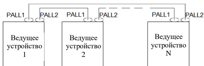
Рисунок 3-13. Схема подключения параллельных кабелей
