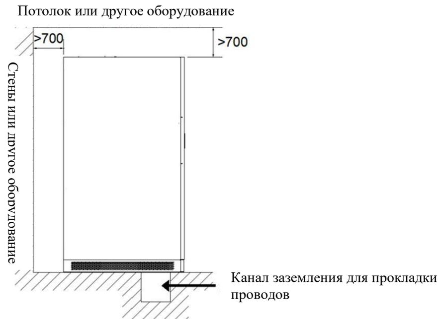
Рисунок 3-2. Схема места установки
