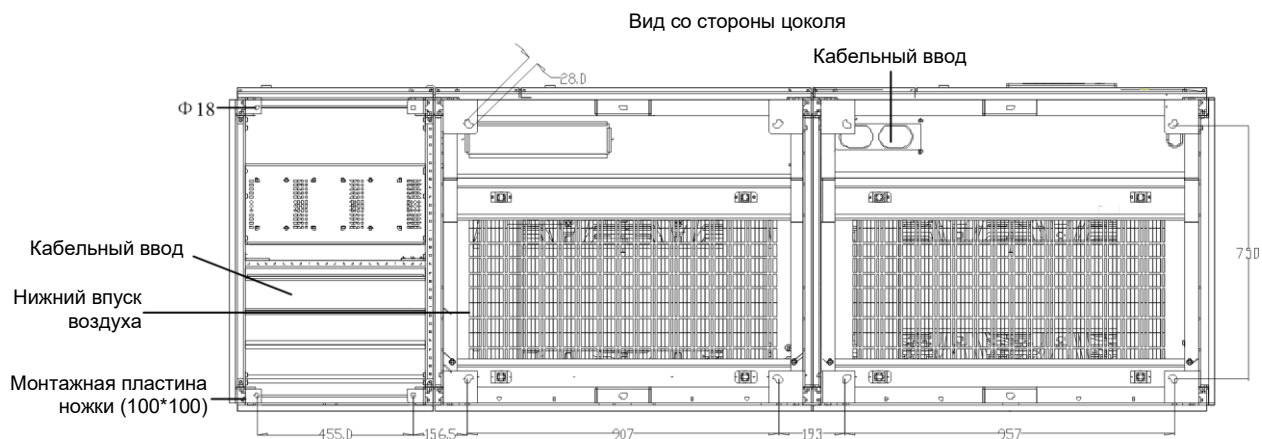
Рисунок 2-26. Вид со стороны цоколя ИБП 600 кВА (все размеры в мм)
