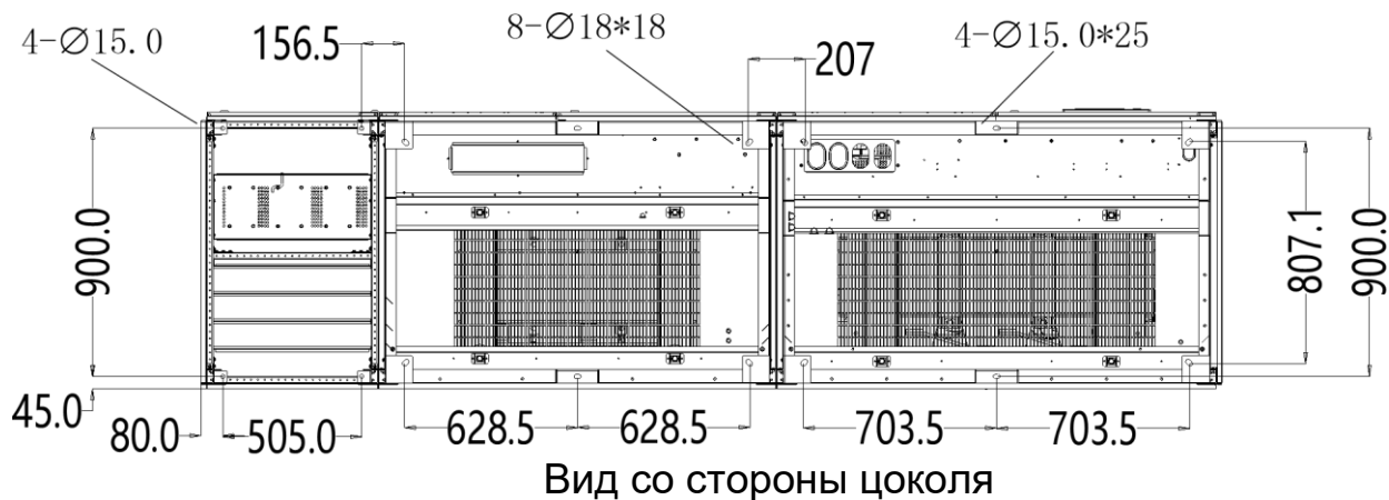
Рисунок 2-28. Вид со стороны цоколя ИБП 800 кВА (все размеры в мм)
