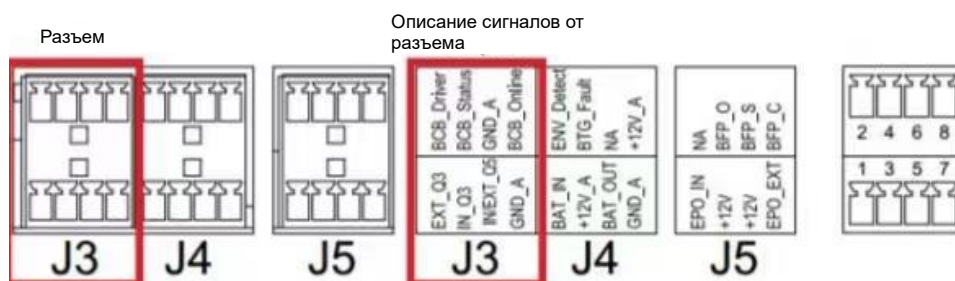
Рисунок 4-6. Интерфейсный разъем состояния выключателя сервисного байпаса, выходного выключателя и батарейного автомата.
