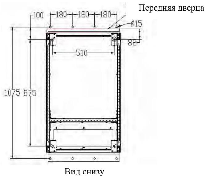
Схема шкафа на 12 модулей
