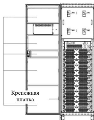
Схема шкафа на 12 модулей
