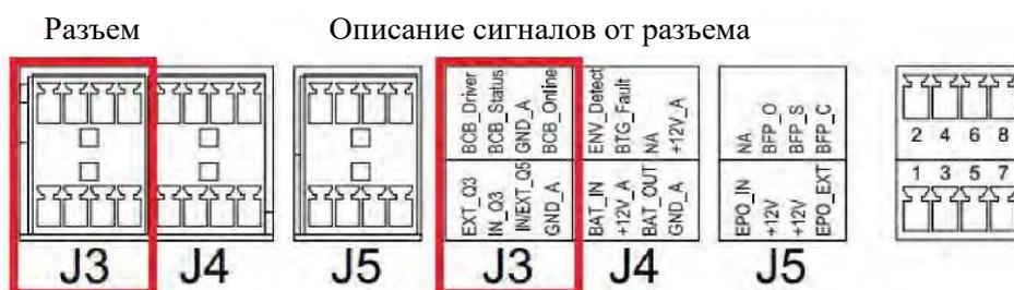
Рисунок 4-7. Интерфейсный разъем состояния выключателя сервисного байпаса, выходного выключателя и батарейного автомата.
