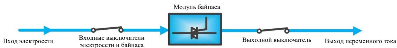
Рисунок 6-7. Принципиальная схема работы в режиме байпаса
